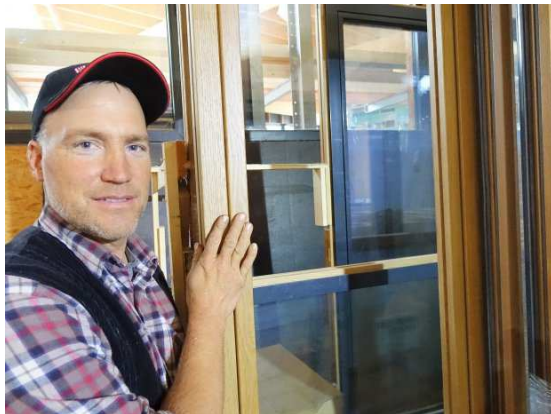
Manuel Diestelmeier streicht über einen Edel-Fensterrahmen: Eichenholz, von außen durch eine Aluschale zusätzlich vor Salz und Feuchtigkeit geschützt
